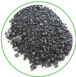
Eisensilikat-Granulat, vergleichbar mit natürlichem vulkanischen Glas, z. B. Obsidian
