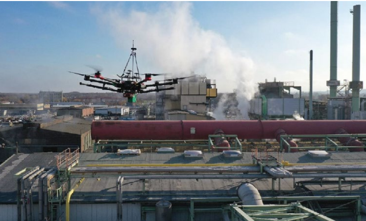
Emissionsmessungen mittels Drohne im Werk Lünen
