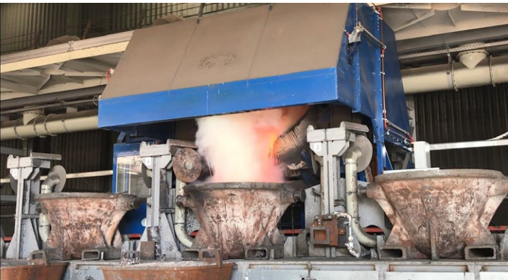
Neue Metallphasentrennlinie mit moderner Absaugtechnik
