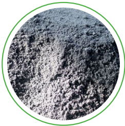
Eisensilikat-Feinstkorn, vergleichbar mit z. B. Gesteinsmehl
