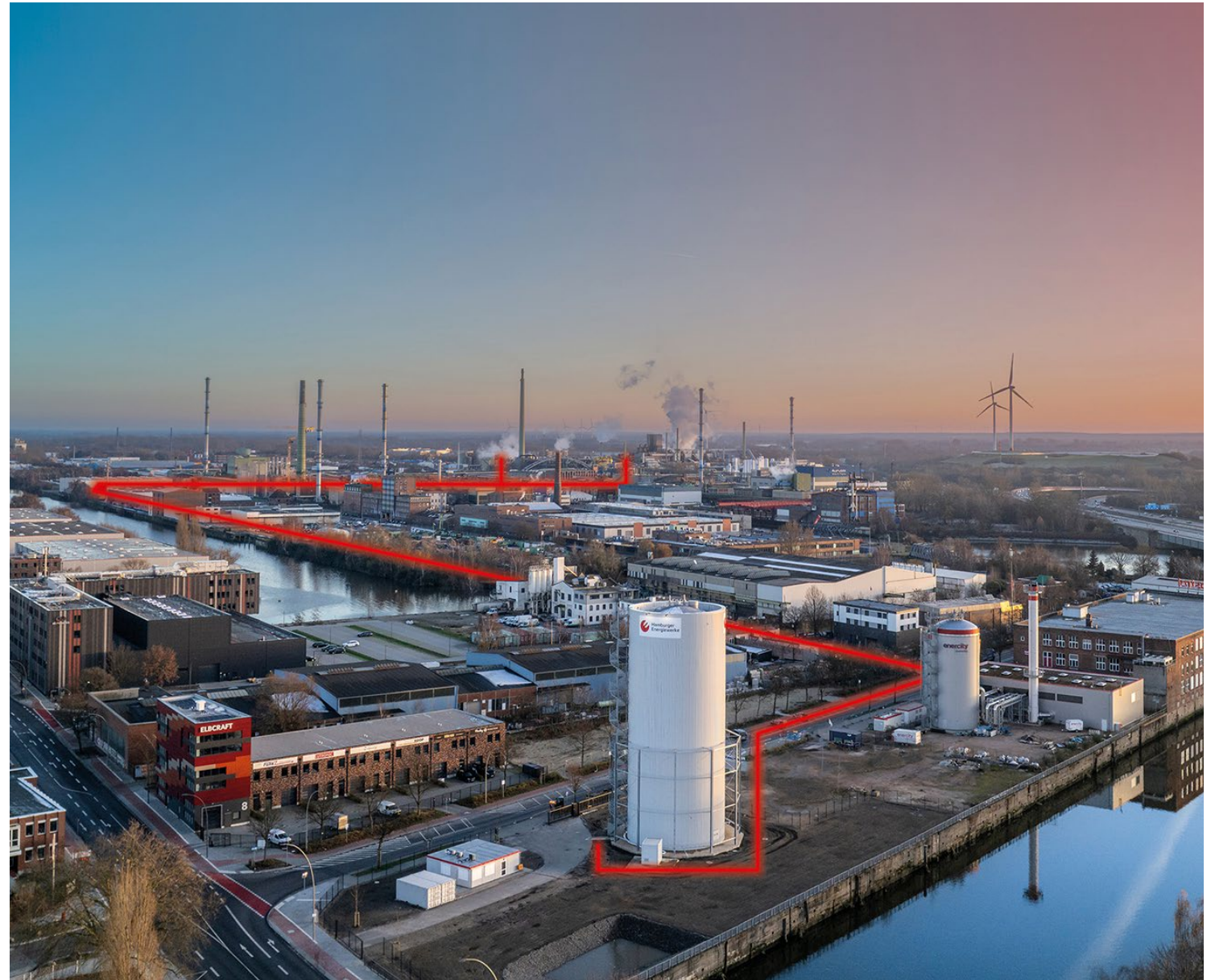
Abb. 2.17: Verlauf der Fernwärmetrasse vom Aurubis-Werk
