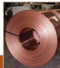
Die Kupferbänder werden den Dachdeckern als Coils angeliefert.
